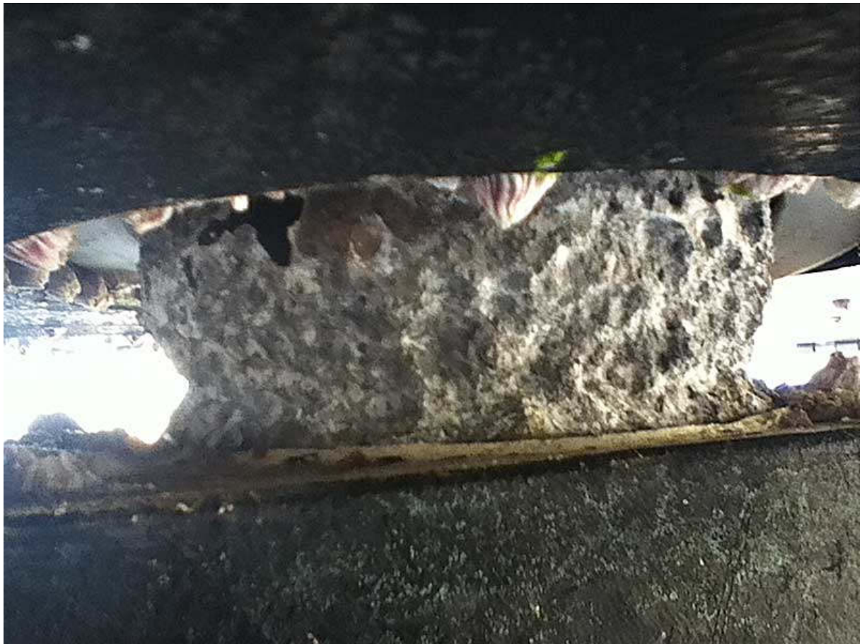
Exemple 4 de corrosion électrochimique extrême causée par une connexion électrique de la mèche de gouvernail avec un autre objet sous-marin comme l'arbre porte-hélice.
