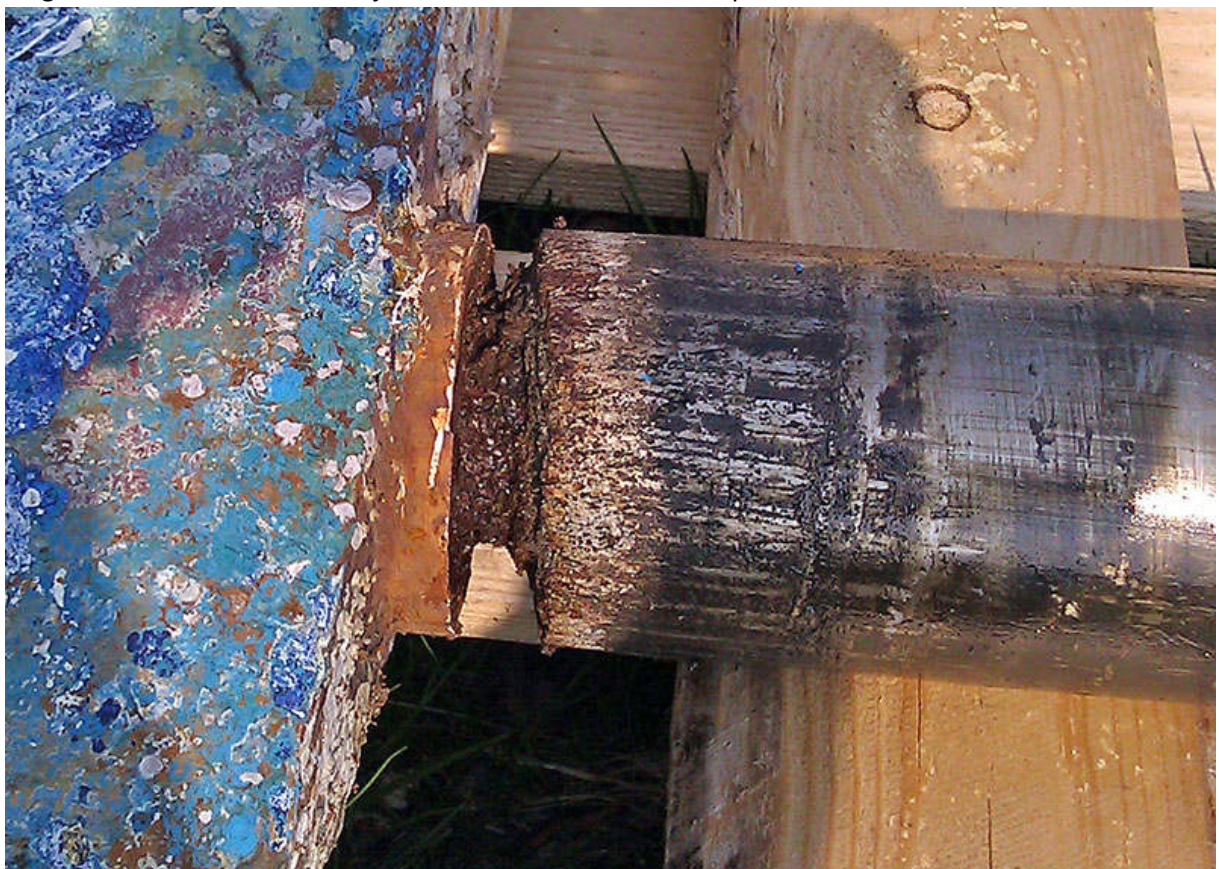
Exemple 4 de corrosion électrochimique extrême causée par une connexion électrique de la mèche de gouvernail avec un autre objet sous-marin comme l'arbre porte-hélice.
