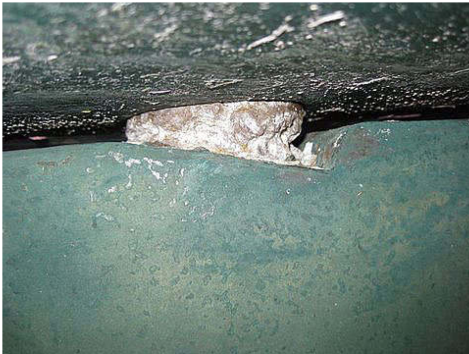
Exemple 1 de corrosion électrochimique causée par une connexion électrique de la mèche de gouvernail avec un autre objet sous-marin comme l'arbre porte-hélice.
