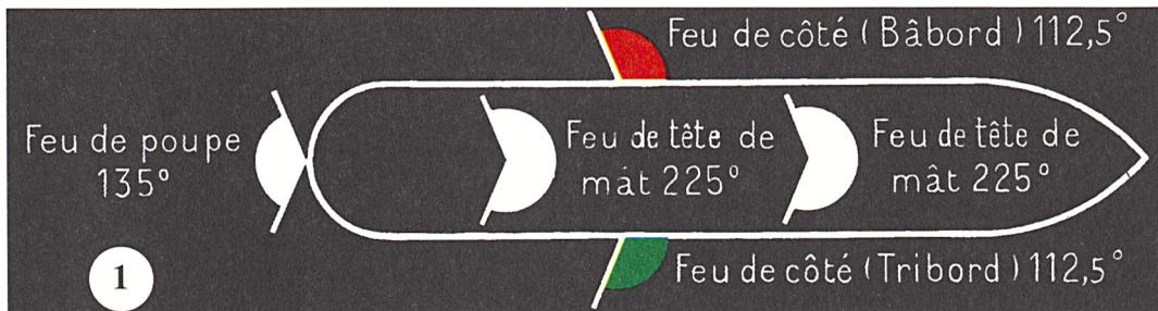
① - Vue schématique en plan des feux d'un navire à propulsion mécanique faisant route (Règles 21 et 23 a).
