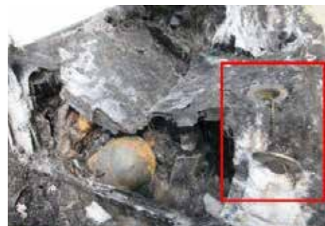
Bouchon de réservoir retrouvé ouvert
