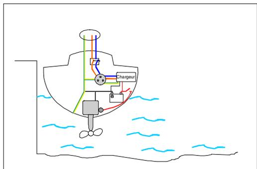
Installation suivant les normes ISO 10133 (12/24 V)
